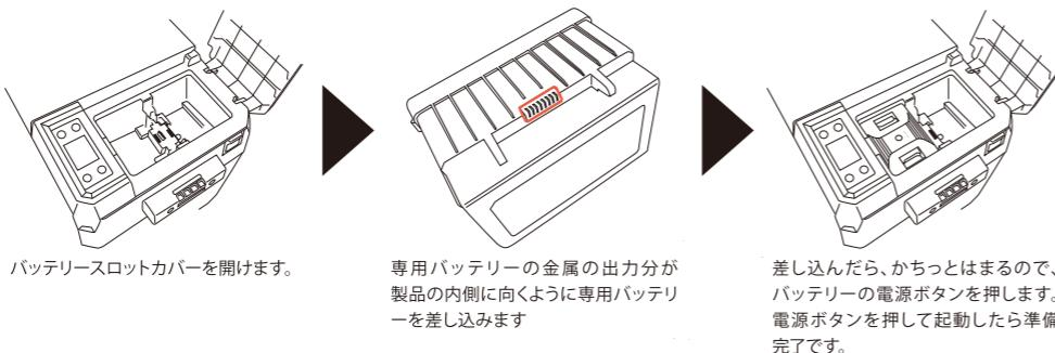
※バッテリーの充電はICEBERG 29Lにバッテリーを接続した状態で行います。ICEBERG 29Lを他の方法で給電しながら稼働すると、自動でバッテリーにも給電されます。バッテリー専用の充電ケーブルはありません。
