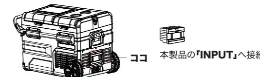
※バッテリーの充電はICEBERG 45Lにバッテリーを接続した状態で行います。ICEBERG 45Lを他の方法で給電しながら稼働すると、自動でバッテリーにも給電されます。バッテリー専用の充電ケーブルはありません。
