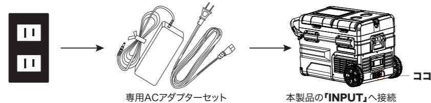
※ 専用ACアダプターが通電している状態(スタンバイ中)では専用ACアダプターのランプは黄緑色に点灯します。
